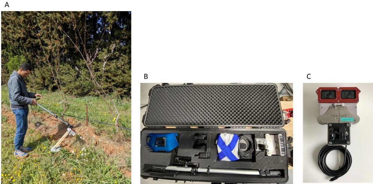
Figure 13. Illustration du système LITERAL. A) acquisitions de mesures avec la perche LITERAL. B) Valise contenant le système LITERAL. C) boîtier d'acquisition des images en stéréo (cf §1.4)
