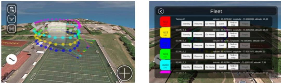
Figura 16 : Imágenes del planificador de la misión y visualización de la trayectoria del enjambre.
